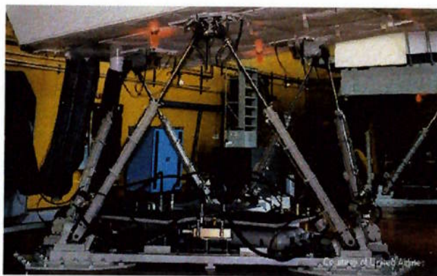
Fig. 3.2 : Detalhe do acionamento da plataforma de um simulador de voo
